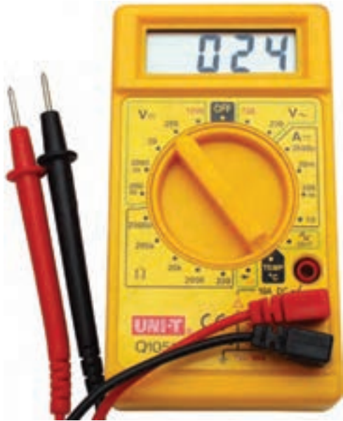
ب) نمای ظاهری مولتی‌متر کتابی دیجیتال با قابلیت اندازه‌گیری درجه حرارت
