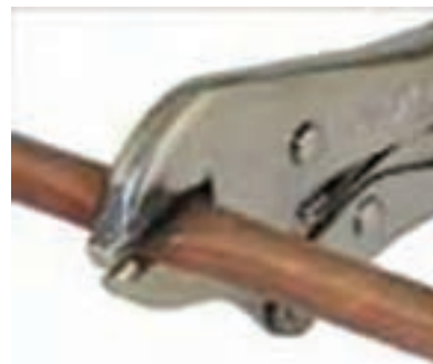
شکل ۱-۳۷- کورکن لوله مسی از نوع انبر قفلی و طریقه‌ی کار با آن
