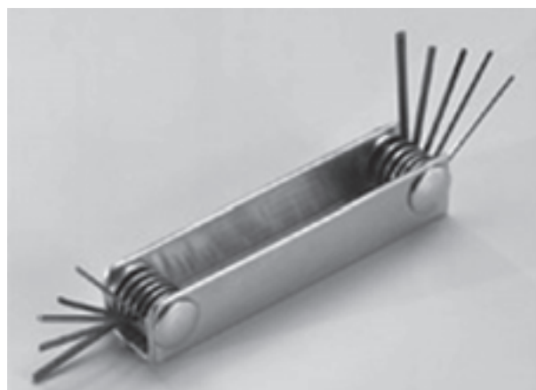
شکل ۶-۱- فیله تعیین قطر داخلی لوله‌ی موین
