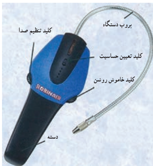
شکل ۲۰-۴- اجزای نشت یاب الکترونیکی
