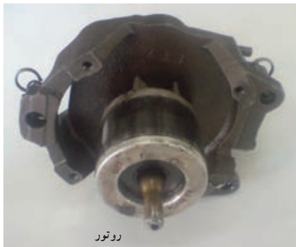
شکل ۱-۲ استاتور و روتور یک کمپرسور بسته ی تناوبی
