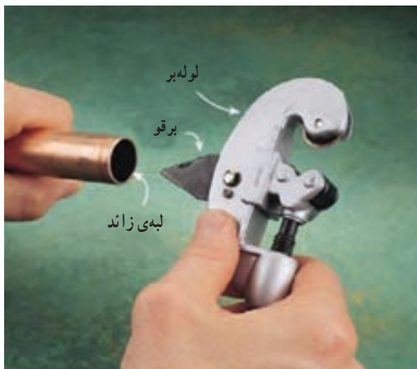
شکل ۱۵-۱- لوله‌بر با برقو مخصوص لوله‌ی مسی
