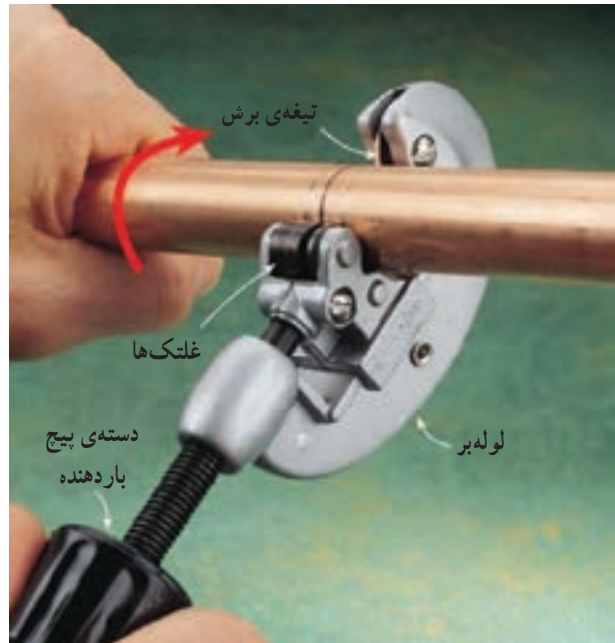
شکل ۱۱-۱- طریقه‌ی بریدن لوله‌ی مسی با لوله‌بر
