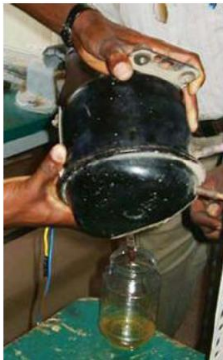
شکل ۱۴: تخلیه روغن از کمپرسور هرمتیک
