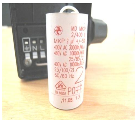
خازن پمپ سیرکولاسیون
